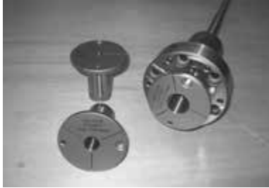
Hydro-Dehndorn-Flansch auf Spindel montiert!!!!
