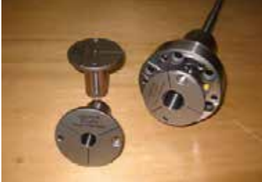
Hydro-Dehndorn-Flansch auf Spindel montiert!!!!
