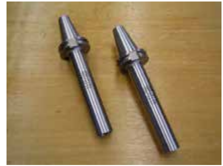
SK-40 x \varnothing 25 x \varnothing 32 x 190 Art.-Nr. 4004-608.00
