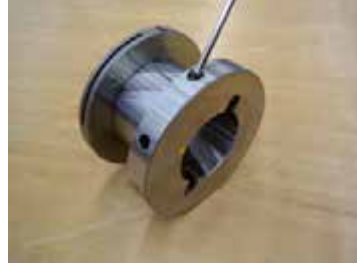
Hydro-Dehndorn-Flansch auf Spindel montiert!!!!
