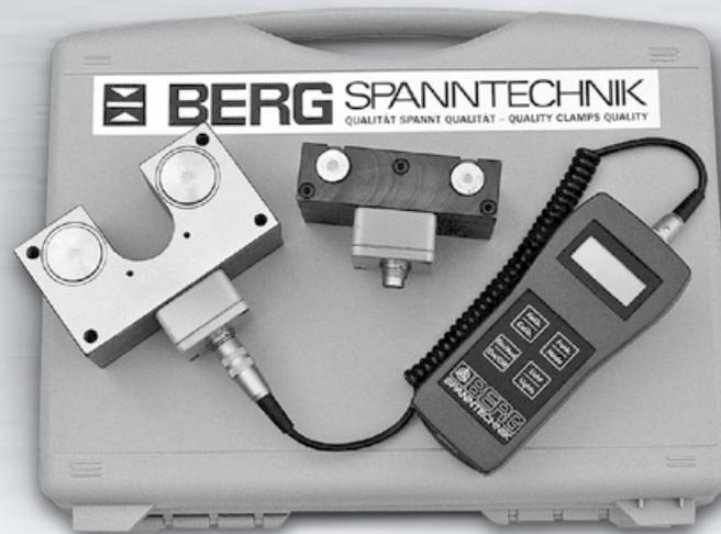
Das BERG-Spannkraftmesssystem ist zur Prüfung der Spannkräfte bei Werkzeugspannsystemen in Umformmaschinen konzipiert.
